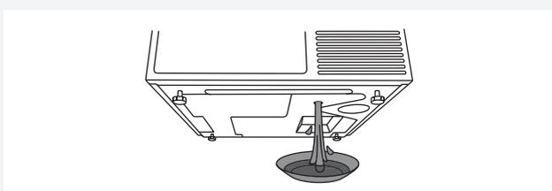
**4** Lorsque l'eau s'est écoulée dans la cuvette, remettez le bouchon en place (sinon l'eau va fuir du sèche-linge lors du prochain séchage).
