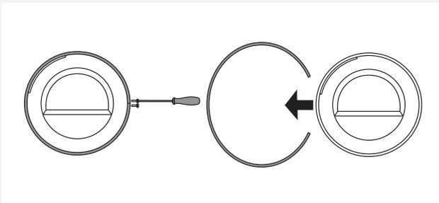
**7** Retirez provisoirement le joint du hublot.
