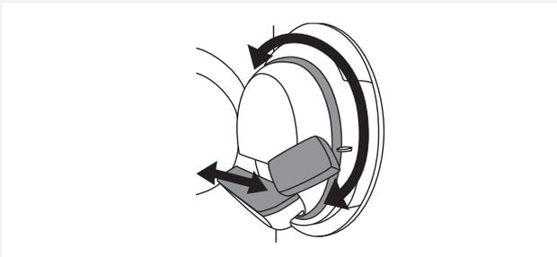
Si nécessaire, nettoyez aussi le logement du filtre et le joint du hublot.
