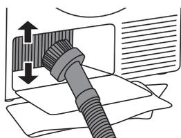
**6** Vous pouvez enlever la poussière et les souillures présentes sur les ailettes métalliques de l'échangeur de chaleur avec un aspirateur équipé d'une brosse souple.
