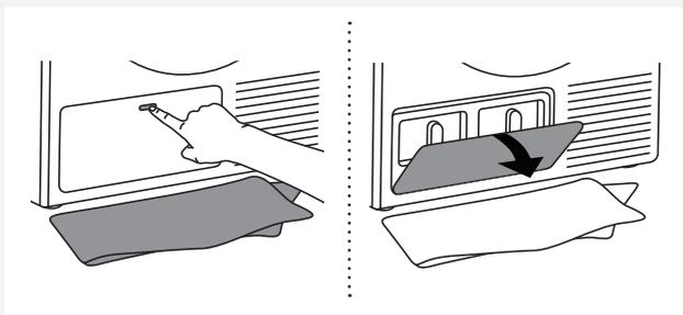
**1** Un peu d'eau peut s'écouler pendant le nettoyage. Il est donc recommandé d'étaler une serpillière sur le sol. Ouvrez la trappe extérieure.
