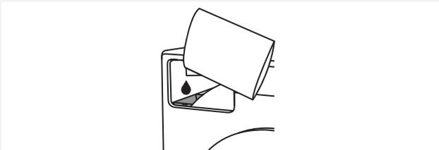
**2** Versez lentement l'eau distillée dans le filtre du réservoir alimentant le générateur de vapeur.
