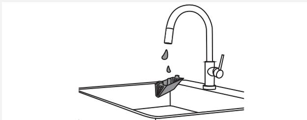
**3** Lavez soigneusement le filtre sous l'eau courante. Si nécessaire, nettoyez aussi la cavité du filtre.
