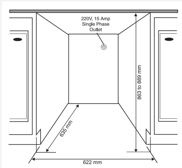
Les sècheuses ASKO peuvent être installées dans un meuble ou sous un comptoir, dans un espace d'une hauteur minimum de 864 mm. Il faut laisser un espace libre d'environ 12 mm tout autour de la machine et un espace minimum de 25 mm entre le bord arrière supérieur de l'appareil et le mur situé derrière lui. L'ouverture doit avoir une largeur minimale de 622 mm.
