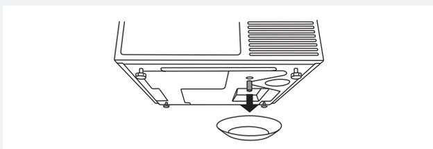
**3** Placez une cuvette vide (de 2 litres environ) sous le bouchon, puis tirez-le pour l'enlever.
