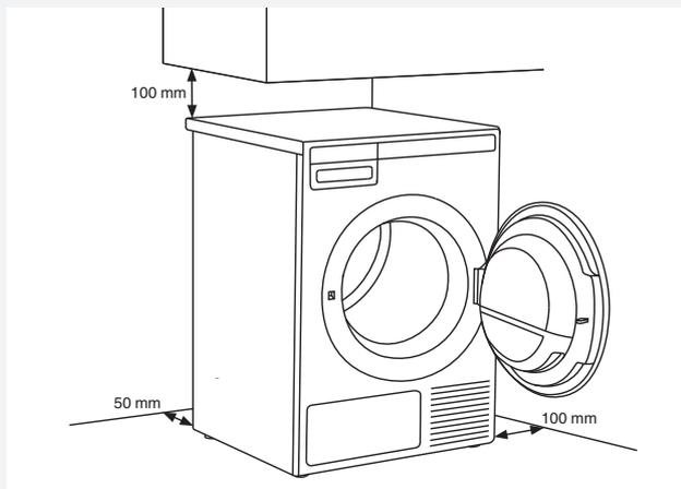
💡 Le sèche-linge ne doit pas toucher le mur ni les meubles adjacents. Pour un séchage optimal, respectez la distance entre l'appareil et le mur, indiquée à la figure.
