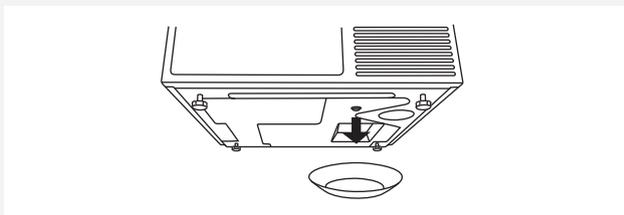
**2** Le bouchon permettant de vider le réservoir du générateur de vapeur est situé dans le fond (à l'avant, à gauche).
