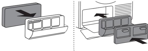
**7** Remontez le filtre en mousse et le logement du filtre.
