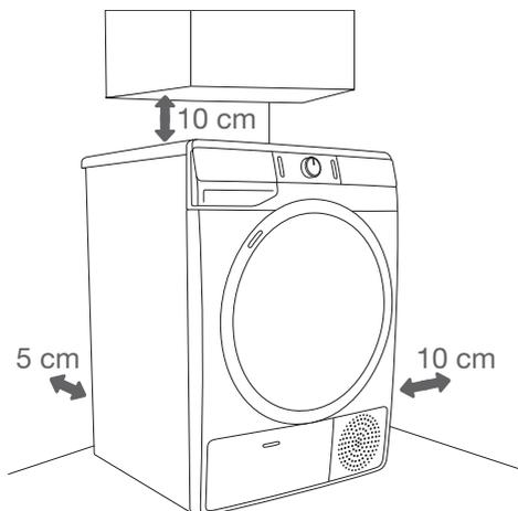
☞ L'appareil ne doit pas toucher le mur ni les meubles adjacents. Pour un fonctionnement optimal, nous vous recommandons de laisser autour de l'appareil un espace libre comme indiquées sur la figure. Si vous ne respectez pas ces distances minimales, le sèche-linge risque de surchauffer.
