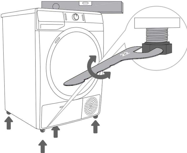
⚠ L'appareil devra être placé sur un sol ayant une chape en béton, dont la surface sera sèche et propre afin d'éviter que l'appareil ne glisse. Les pieds réglables devront être nettoyés avant l'installation.
