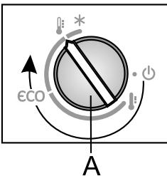
Si la température de la pièce dans laquelle l'appareil est installé est inférieure à 16°C, nous vous recommandons de régler le bouton **A** vers l'icône
