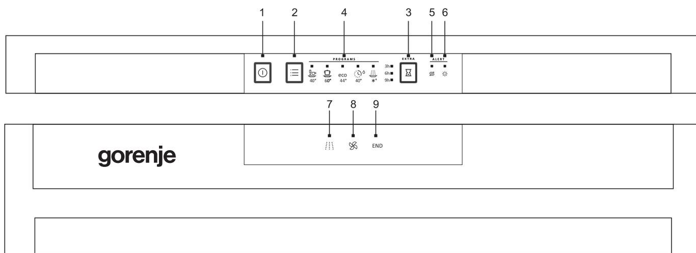
1. Interrupteur Marche/Arret: pour allumer/eteindre l'appareil.
