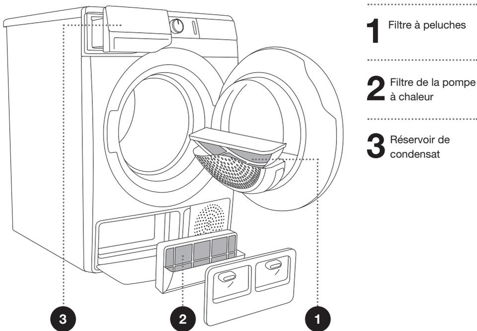
⚠ Le sèche-linge ne doit jamais fonctionner sans ses filtres ou avec des filtres abîmés, car une accumulation excessive de peluches provenant des vêtements pourrait entraîner un dysfonctionnement ou une défaillance de l'appareil.
