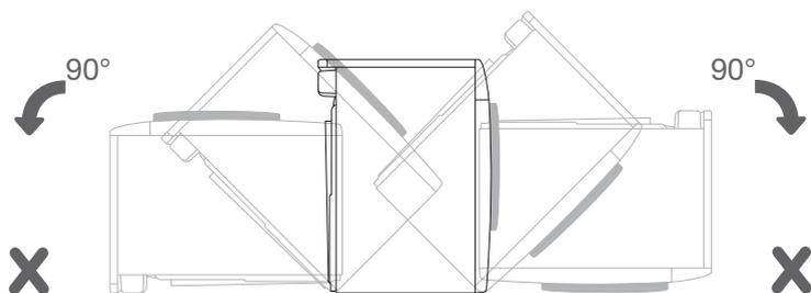
⚠ Après avoir installé l'appareil, attendez 24 heures sans le manipuler avant de l'utiliser. Si vous devez le coucher sur le côté pendant le transport ou lors d'une réparation, placez-le sur le côté gauche, appareil vu de face.
