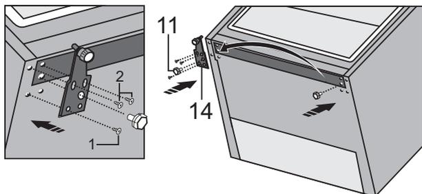
14. Positionnez la porte inférieure sur la charnière inférieure et maintenez-les en place. Faites pivoter la charnière centrale de 180°. Placez la rondelle dans la bonne position et ajustez la position de la charnière centrale de façon à pouvoir installer et fixer la porte inférieure.
