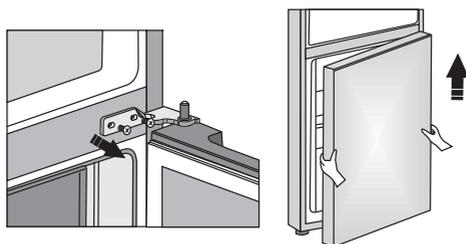
9. Posez la porte inférieure sur une surface lisse. Enlevez la vis (8) et retirez le rétenteur de porte (10) et la butée (9). Fixez ensuite le rétenteur de porte fourni dans le sachet et la butée (9) avec la vis (8). Conservez le rétenteur de porte (10) au cas où vous en auriez besoin ultérieurement.
