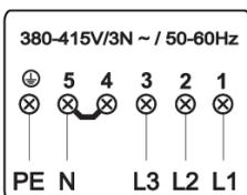
3 phases, 1 conducteur neutre (380-415 V 3N~, 50-60 Hz).
