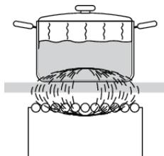
Un champ magnétique est généré dans l'appareil. En plaçant une casserole avec une base en fer sur un foyer de cuisson, un courant est induit dans la base de la casserole. Ce courant induit génère de la chaleur à la base de la casserole.
