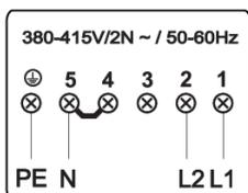
2 phases, 1 conducteur neutre (380-415 V 2N~, 50-60 Hz)
