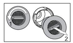
Pour remplacer le filtre à air :
