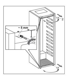
Dévissez complètement les vis (2). Puis, vissez-les partiellement dans les trous en haut et en bas du côté opposé du châssis.
