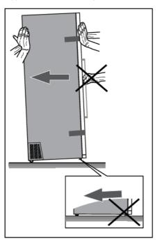
Lorsque vous déplacez l'appareil, veillez à ne pas le pousser sur le sol. Vous pourriez l'endommager. Deux roulettes se trouvent à l'arrière du boîtier de l'appareil pour faciliter le déplacement de ce dernier.
