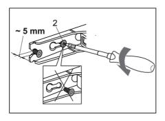
Desserrez partiellement (de 5 mm au maximum) les vis des charnières (2) en haut et en bas. Ne les dévissez pas complètement. De cette façon, la porte restera en contact avec le châssis.
