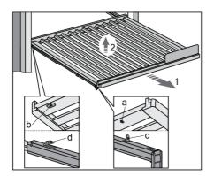
Pour retirer une clayette de l'appareil, sortez complètement les rails télescopiques (1), puis soulevez verticalement la clayette (2) pour la retirer des rails. Faites attention à ne pas endommager le joint de porte.
