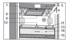
La zone de service (zone B) est une zone de température située entre la cloison d'isolation supérieure (5) et inférieure (15). Elle vous permet d'amener le vin à la température idéale de consommation, et de préparer à l'avance tout ce dont vous avez besoin pour un service rapide et de qualité : verres à vin réfrigérés, espace pour les bouteilles déjà ouvertes, carafe, et autres accessoires (décapsuleurs, becs verseurs, bouchons...).
