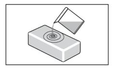
Remplir la boîte avec 0,5 litre d'eau du robinet et la placer dans la zone appropriée. Il n'y a pas de positions préférables, tant qu'elle est placée dans la bonne zone.
