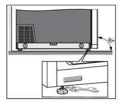
Lorsque l'appareil est placé sur la surface prévue, il doit être complètement à niveau afin de réduire les vibrations. Pour mettre l'appareil à niveau, utilisez les pieds réglables à l'avant de l'appareil. Une clé ouverte de taille 17 est nécessaire pour régler et fixer les pieds.
