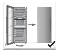
15. Fermez la porte et assurez-vous qu'elle est bien alignée avec le châssis. Le côté du châssis et le bord de la porte doivent être parallèles.
