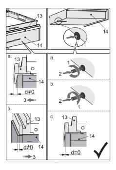
Si la clayette (13) et le tiroir (14) ne sont pas alignés à l'avant (d≠0), il faut d'abord sortir complètement le tiroir pour accéder au mécanisme d'ouverture du tiroir sur la paroi arrière. Appuyez sur la cale d'espacement (A) pour libérer le mécanisme. Faites tourner la cale d'espacement pour régler la longueur.
