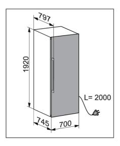
• Les dimensions de l'appareil sont indiquées sur le schéma.
