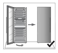
Ajustez la position de la porte jusqu'à ce que le bord de la porte soit parallèle au côté du châssis.
