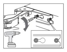
11. Serrez les vis. Les vis doivent être serrées à un couple de 6,2 Nm.
