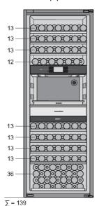
La configuration de base de l'appareil permet de stocker jusqu'à 139 bouteilles de Bordeaux.
