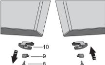
Posez la porte inférieure sur une surface lisse. Enlevez la vis (8) et retirez le rétenteur de porte (10) et la butée (9). Fixez ensuite le rétenteur de porte fourni dans le sachet et la butée (9) avec la vis (8). Conservez le rétenteur de porte (10) au cas où vous en auriez besoin ultérieurement.
