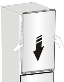
Placez la porte supérieure dans la position correcte et fixez la charnière supérieure (3) avec les vis (2). Maintenez la porte supérieure en place pendant que vous les positionnez.
