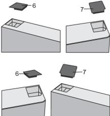
Retirez le cache-trou (6) sur le côté gauche de la porte supérieure. Enlevez ensuite le cache-trou (7) sur le côté droit de la porte supérieure. Insérez le cache-trou (7) sur le côté gauche de la porte supérieure et insérez le cache-trou (6) sur le côté droit de la porte supérieure.
