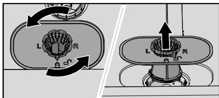
1. Tournez la bague de verrouillage dans le sens inverse des aiguilles d'une montre et soulevez le filtre à la verticale.
