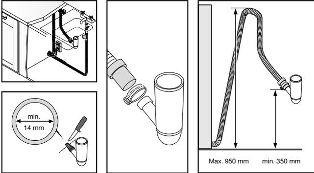
Le tuyau de vidange peut être rallongé de 3 m maximum (sa longueur totale ne doit pas excéder 4,5 m). Tous les joints et tubes de raccord doivent présenter un diamètre intérieur d'au moins 14 mm.
