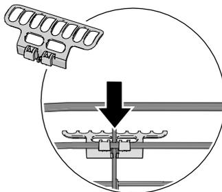
Installez le porte-couverts pour obtenir une capacité de chargement maximale. (À l'intérieur du sac en plastique inclus.)
