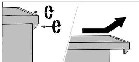
Le lave-vaisselle peut également être installé dans une niche sans son plan de travail. Si le plan de travail du lave-vaisselle est retiré, le lave-vaisselle doit être installé sous un plan de travail séparé.
