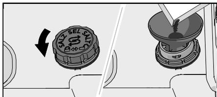
Pour une alimentation en eau d'une dureté supérieure à 5 °dH (9 °fH / 6 °eH / 0,9 mmol/l), remplir de sel.
