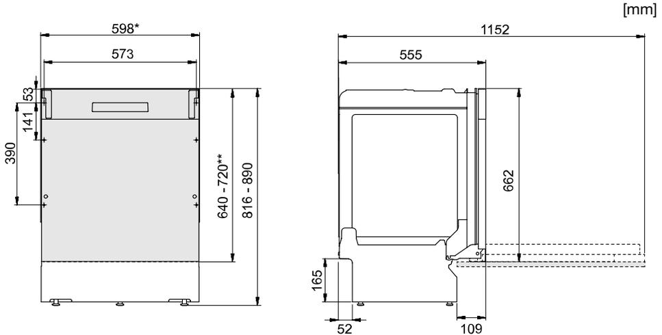
\*Retirez les bandes de plastique si la dimension de l'évidement est de 596-598 mm. Faites attention ! Les bords peuvent être tranchants. Portez des gants de protection !
