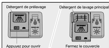
Si du détergent pour lave-vaisselle en poudre ou liquide est utilisé, ajoutez une petite quantité de détergent dans le compartiment pour détergent de pré-lavage.
