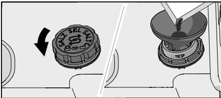
1. Retirez le couvercle du compartiment à sel en le faisant tourner dans le sens inverse des aiguilles d'une montre.
