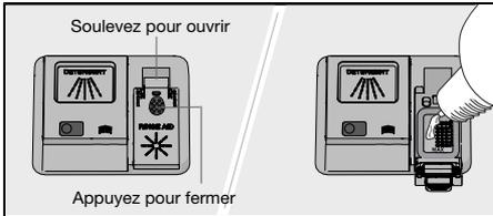
1. Ouvrez le couvercle du compartiment du liquide de rinçage.
