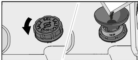
1. Retirez le couvercle du compartiment à sel en le faisant tourner dans le sens inverse des aiguilles d'une montre.
