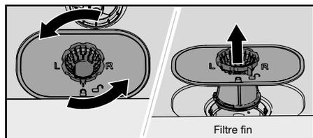
1. Tournez la bague de verrouillage dans le sens antihoraire et soulevez le filtre fin à la verticale.
