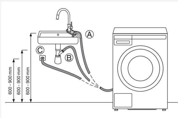
Le flexible de vidange peut aussi être raccordé directement au siphon d'un évier. Dans ce cas, l'embouchure du tuyau devra être à 600 – 900 mm au-dessus du sol. Le diamètre interne du raccord devra être de 18 mm au moins. Voir la figure.
