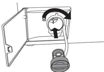
**6** Remettez le filtre en place comme indiqué sur la figure, en le tournant dans le sens des aiguilles d'une montre. Pour assurer l'étanchéité, la surface du joint doit être exempte de saillies. Remettez en place le tube de vidange.
