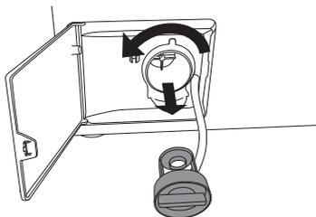
**3** Tournez lentement le filtre dans le sens contraire des aiguilles d'une montre et retirez-le.
