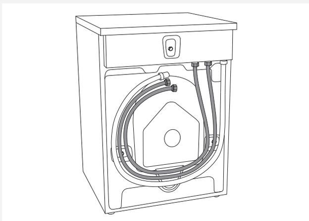
L'écrou du flexible d'alimentation doit être serré assez fermement pour éviter les fuites. Après avoir vissé l'écrou, vérifiez que l'eau ne fuit pas.
