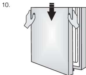
Placez la porte sur la charnière inférieure et utilisez les vis (2) pour fixer la charnière supérieure (3). Maintenez la porte en place tout en la positionnant.
