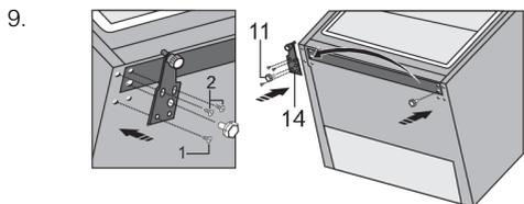
Fixez la charnière (14) sur le côté opposé à l'aide des vis. Les vis doivent être fixées dans l'ordre indiqué sur la figure ci-dessous. Tout d'abord, serrez la vis 1, puis les vis 2. Ensuite, vissez les pieds réglables (11).
