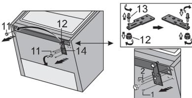
Dévissez les trois vis de la charnière inférieure (14) et retirez-la. Retirez le pied supplémentaire (12) de l'axe de charnière inférieur (13). Dévissez la goupille (13) de la charnière inférieure et vissez-la sur le côté opposé de la charnière, avec le pied supplémentaire (12).
