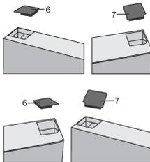
Enlevez le couvercle (6) du côté gauche de la porte. Enlevez ensuite le couvercle (7) du côté droit de la porte. Placez le couvercle (7) sur le côté gauche de la porte et placez le couvercle (6) sur le côté droit de la porte.
