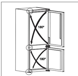
5. Fixez la charnière inférieure avec les vis, puis faites glisser la porte inférieure sur le pivot de la charnière inférieure et maintenez-la en position. Ajustez les charnières du milieu à la position de l'appareil, puis vissez-les en vous assurant que la porte inférieure reste bien en place.
