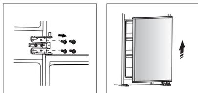
4. Faites passer les cache-trous du côté gauche vers le côté droit, et vissez les charnières des portes sur le côté opposé (comme indiqué sur la figure ci-dessous).
