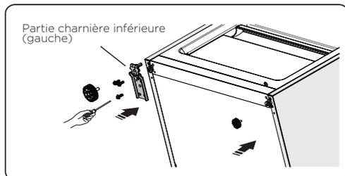
14. Insérez la porte inférieure sur l'axe de charnière inférieur et maintenez-la en position. Tournez la charnière centrale de 180°, changez la rondelle sur l'axe vers le côté inférieur, ajustez la charnière centrale à la position appropriée, puis installez-la en veillant à ce que la porte inférieure soit bien fixée.
