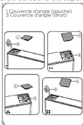
7. Desserrez la vis 3 et retirez la pièce 2 et la pièce 1 ; installez la butée de porte de rechange gauche 4 fourni (dans le sac en plastique) et la pièce 2 (tampon) sur le côté gauche avec la vis 3. Conservez la pièce 1 avec l'appareil pour référence ultérieure.
