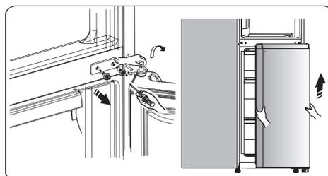
9. Couchez la porte inférieure sur une surface lisse avec son panneau vers le haut. Desserrez la vis 3 et retirez la pièce 2 et la pièce 1. Installez la butée de porte de rechange gauche 4 fourni (dans le sac en plastique) et la pièce 2 (tampon) sur le côté gauche avec la vis. 3. Conservez la pièce 1 avec l'appareil pour référence ultérieure.
