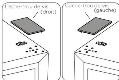
6. Retirez la pièce 1 du côté supérieur gauche du couvercle supérieur. Retirez ensuite la pièce 3 du côté supérieur droit du couvercle supérieur. Installez la pièce 1 du côté supérieur droit du couvercle supérieur.
