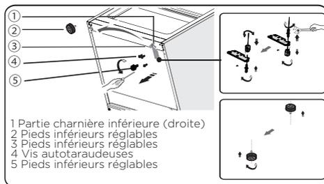
12. Retirez la pièce 3 de l'axe de charnière inférieur, desserrez l'axe de charnière inférieur, mettez-le sur l'emplacement du trou inverse, puis serrez-le en position ; installez ensuite la pièce 3 sur l'axe de charnière inférieur.
