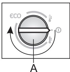
**Pour mettre l'appareil en marche,** tournez le bouton **A** dans le sens des aiguilles d'une montre.
