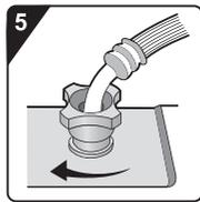
**1** Fermez le robinet et dévissez le tuyau d'entrée à l'arrière de l'appareil.
