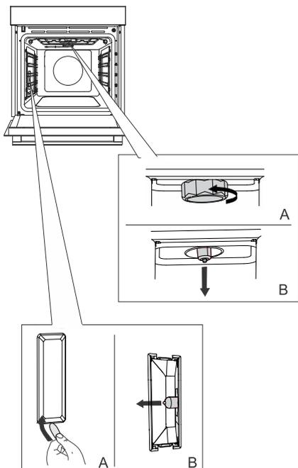
**1** Dévissez et retirez le couvercle (dans le sens inverse des aiguilles d'une montre). Retirez l'ampoule halogène.
