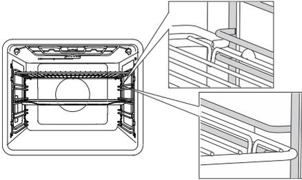
Dans le cas des guide-fils, insérez toujours la grille et les plaques de cuisson dans la fente située entre la partie supérieure et inférieure de chaque niveau de guidage.
