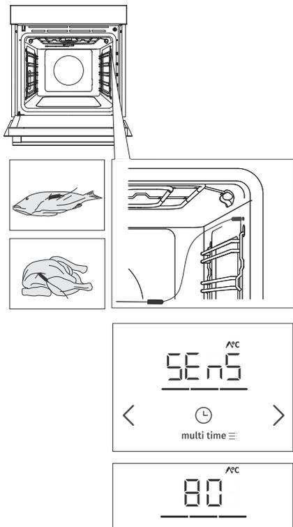
1 Enfoncez l'extrémité métallique de la sonde dans la partie la plus épaisse de l'aliment.
