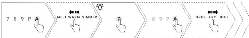
1. Le fait d'appuyer sur la touche **A** permet d'ouvrir le menu supplémentaire. Les chiffres du curseur sur la zone de cuisson sélectionnée disparaissent et des fonctions supplémentaires s'affichent.
