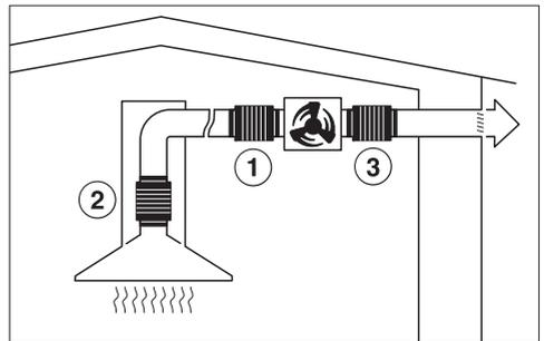
Afin de limiter au maximum les bruits de ventilation dans la cuisine, le réducteur de bruit doit être placé le plus près possible devant le moteur externe ①. Si le conduit d'évacuation est très long, le réducteur de bruit doit être placé sur le raccord d'évacuation de la hotte ②. Si vous utilisez un moteur externe installé en intérieur (ABLG 202), vous pouvez limiter les bruits de ventilation en plaçant un amortisseur de bruit derrière le ventilateur externe ③.
