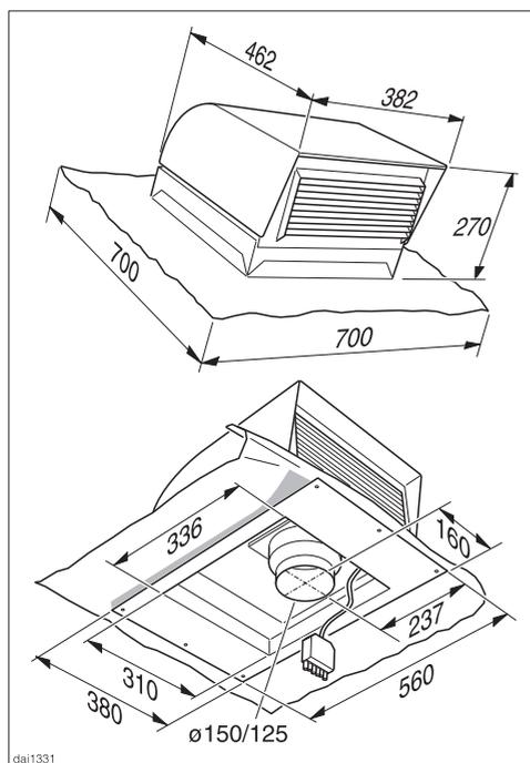
Le ventilateur de toit DDG 102 est prévu pour un montage sur toit incliné en tuile, en tuile de béton, en ardoise ou sur toit de bardeaux. L'inclinaison du toit doit être d'au minimum 22° afin qu'aucune précipitation, comme la pluie ou la neige, ne puisse pénétrer.
