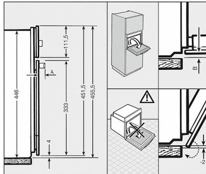
Schéma détaillé H 6000 BM, PureLine et ContourLine (schéma)
