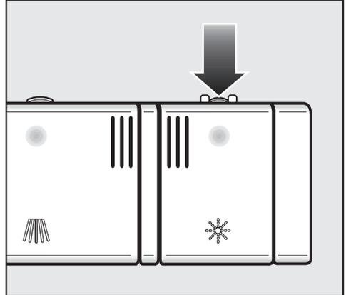
■ Appuyer sur la touche d'ouverture de la porte sur le couvercle du bac de produit de rinçage en suivant la direction de la flèche. Le couvercle s'ouvre.
