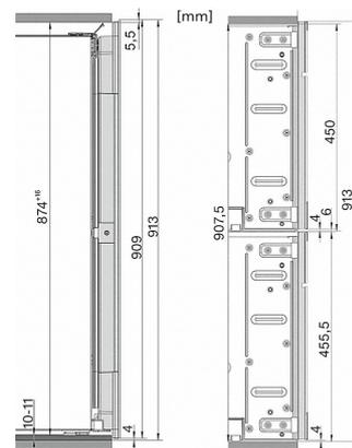
KWT6422iG, schéma, combinaison d'appareils de 45 cm
