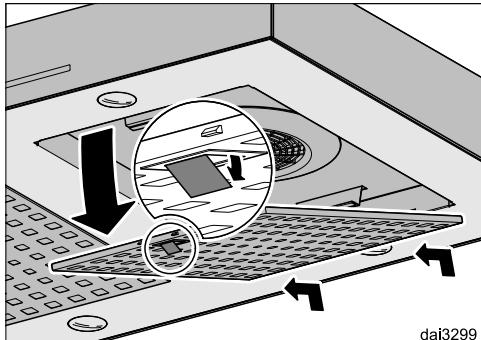
■ Ouvrez le verrouillage du filtre à graisses, faites basculer le filtre vers le bas, à un angle d'environ 45°, décrochez-le et retirez-le.
