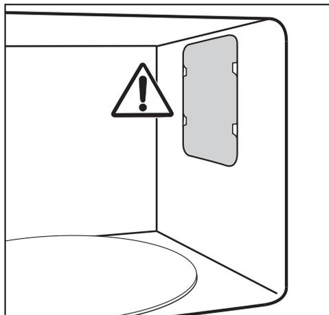
N'enlevez ni le cache de protection de l'orifice de sortie des micro-ondes dans l'enceinte ni le film posé à l'intérieur de la contreporte.
