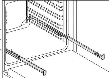
Les rails coulissants FlexiClips peuvent uniquement être placés aux niveaux 1, 2 et 3.
