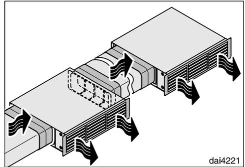
Sie können mehrere Umluftboxen miteinander verbinden. Dadurch werden eine höhere Geruchsreduzierung, eine höhere Luftleistung und eine geringere Strömungsgeschwindigkeit an den Ausblasgittern erreicht.
