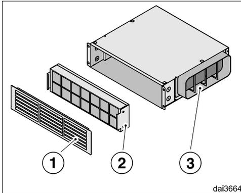
El aire aspirado se limpia a través del filtro de grasa y se conduce a la caja de recirculación. Aquí el aire se limpia adicionalmente a través de un filtro de olores regenerable ② y se conduce de vuelta a la cocina a través de la rejilla de salida ①.
