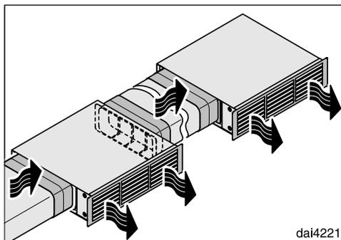
Flere recirkulationsbokske kan forbindes med hinanden. Derved opnås en større lugtreduktion, en højere lufteffekt og en mindre gennemstrømningshastighed gennem udblæsningsåbningerne.
