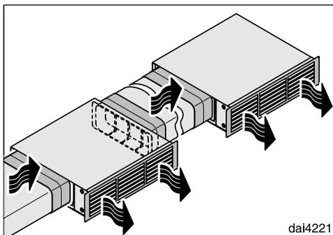
Du kan koble sammen flere omluftsboxer. Gjennom dette oppnås høyere lukt-reduksjon, høyere luffteffekt og lavere strømnings-hastighet på utblåsningsgitteret.
