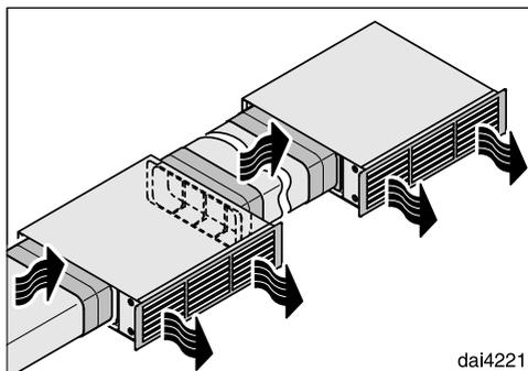
Вы можете соединить между собой несколько комплектов для переоборудования. Это поможет нейтрализовать неприятные запахи, увеличит производительность по воздуху и повысит скорость потока всасываемого воздуха на вентиляционных решётках.
