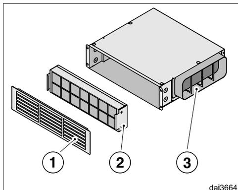
Luften som suges inn renses av fettfilteret i ventilatoren. Deretter føres luften inn i omluftsboxen, hvor den i tillegg blir rensert av et luktfiler ②. Luften føres så gjennom utblåsningsgitteret ① tilbake til kjøkkenet igjen.
