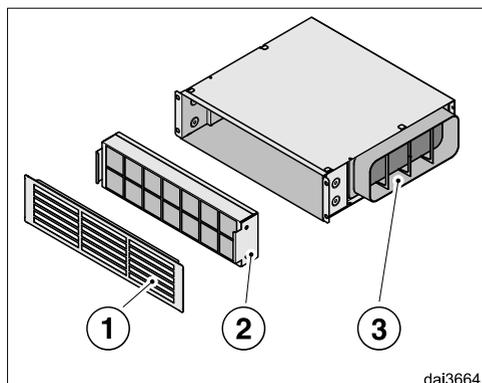
L'aria aspirata viene pulita dai filtri anti-grasso della cappa aspirante e immessa nel kit di modifica ricircolo. Qui l'aria viene pulita inoltre da un filtro antiodore rigenerabile ② e reimpressa in cucina attraverso la griglia di fuoriuscita dell'aria ①.
