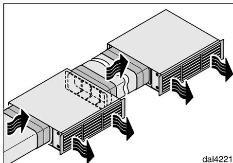
Μπορείτε να συνδέσετε περισσότερα κουτιά κυκλοφορίας αέρα μεταξύ τους. Έτσι επιτυγχάνεται μείωση οσμών, μεγαλύτερη απορροφητική ισχύς και μικρότερη ταχύτητα ροής στις γρίλιες εξαγωγής αέρα.
