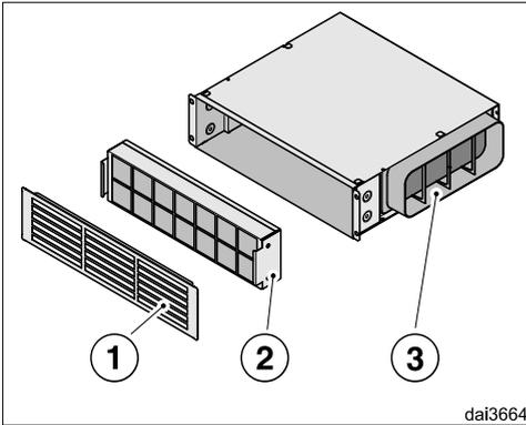
Rasvansuodattimet puhdistavat liesituulettimen imemän ilman ja johtavat sen ilmankierrätysyksikköön. Siellä ilma virtaa elvytettävän aktiivihilisuodattimen ② läpi, joka puhdistaa sitä edelleen ja johtaa sen poistoilmaritilän ① kautta takaisin huoneilmaan.
