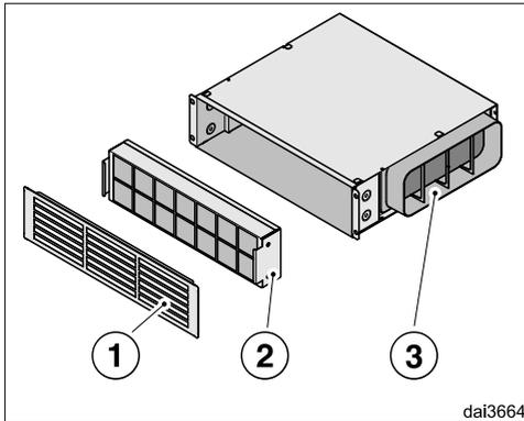
Die angesaugte Luft wird durch die Fettfilter der Dunstabzugshaube gereinigt und in die Umluftbox geführt. Hier wird die Luft zusätzlich durch einen regenerierbaren Geruchsfilter ② gereinigt und durch das Ausblasgitter ① in die Küche zurückgeführt.
