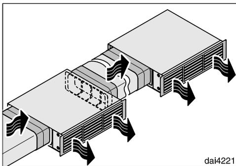
Можна об'єднати кілька циркуляційних відсіків. Це підвищить потужність потоку повітря та ефективність абсорбування запахів, а також знизить швидкість потоку з випускної решітки.
