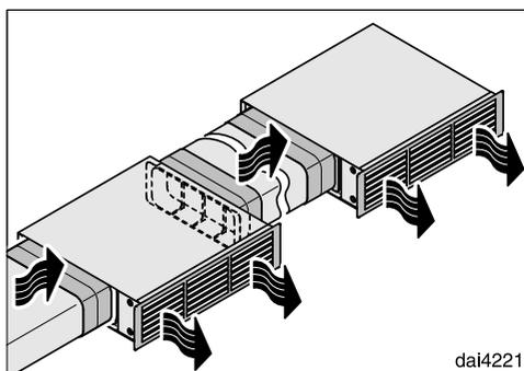
U kunt meerdere luchtcirculatieboxen met elkaar verbinden. Daardoor wordt de geur gereduceerd, neemt het afzuigvermogen toe en wordt de stroomsnelheid bij de uitblaasroosters verlaagd.
