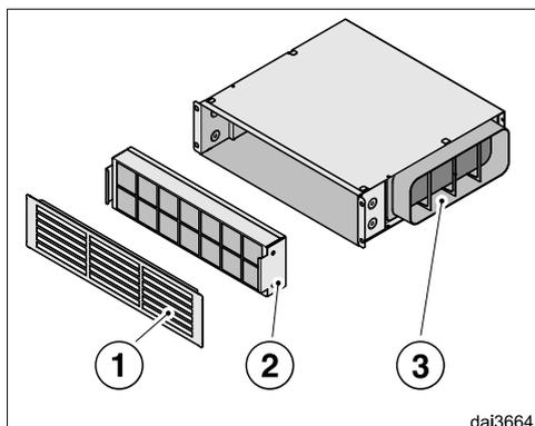
Den ind sugede luft renses af emhæt- tens fedtfiltere og ledes ind i recirkulati- onsboksen. Her renses luften yderligere af et regenererbart lugtfilter ②, hvorefter den ledes tilbage til køkkenet gennem udblæsningsgitteret ①.
