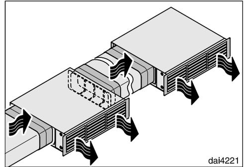
Es posible conectar varias cajas de recirculación entre ellas. Así se consigue una fuerte reducción de los olores y una gran potencia de extracción y se reduce la corriente de aire en la zona de las rejillas de salida de aire.
