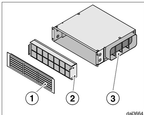
Всмоктане повітря очищується жиропоглинальним фільтром у витяжці і подається у циркуляційний відсік. Тут повітря додатково очищується вугільними фільтрами ② і подається в кухню через випускну решітку ①.
