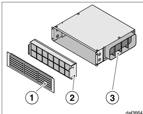
Zrak, ki ga napa vsesa, se prečisti preko maščobnih filtrov in je nato speljan v enoto za kroženje zraka, kjer se dodatno prečisti skozi obnovljiv filter z aktivnim ogljem ②. Na koncu se zrak skozi mrežo za izhodni zrak vrne v kuhinjo.
