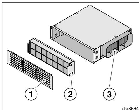
L'air aspiré est nettoyé par les filtres à graisses de la hotte et passe dans le kit de recyclage. L'air recyclé est par ailleurs nettoyé par un filtre à charbon actif régénérable (2) puis est renvoyé dans la cuisine par la grille d'aération (1).
