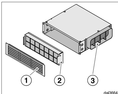
Nasátý vzduch je čištěn tukovými filtry odsávače par a veden do boxu pro cirkulační provoz. Zde je vzduch navíc čištěn regenerovatelným pachovým filtrem ② a přes rozdělovač vzduchu ① veden zpět do kuchyně.
