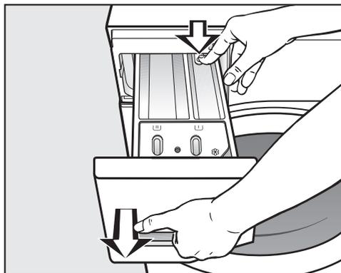
■ Ouvrez le bac à produits jusqu'à la butée, pressez le bouton de déverrouillage et sortez entièrement le bac à produits.
