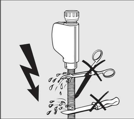
⚠ Le tuyau d'arrivée ne doit **pas** être raccourci ou abîmé étant donné qu'on y trouve des éléments sous tension (voir fig.).
