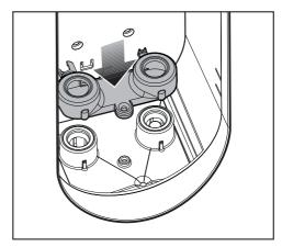
■ Replacez le capot du filtre à eau sur les deux supports.
