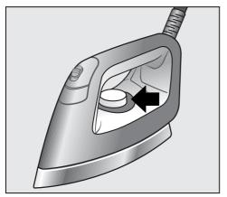
La température de repassage se règle à l'aide du thermostat situé sur le fer à repasser.
