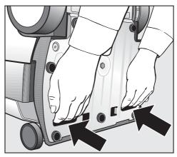
Utilisez les deux poignées situées sur la partie inférieure de l'appareil pour le transport.
