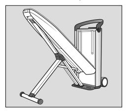
Maintenez la poignée de déclenchement tirée tout en guidant la table à repasser jusqu'en butée à un angle de 45°.
