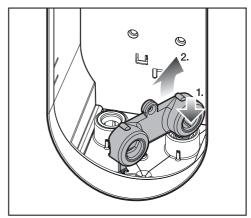
Poussez l'outil rond de maintien du capot de filtre à eau par le haut sur le filtre à eau.
