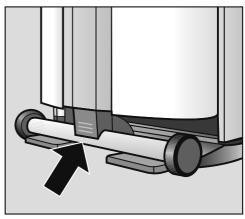
Appuyez l'extrémité du châssis en X qui dépasse encore contre la table à repasser jusqu'à ce qu'elle s'enclenche.
