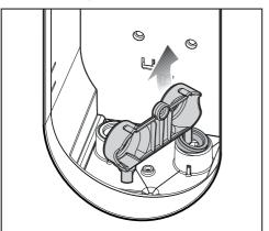
Retirez la bague d'étanchéité sur le support de droite à l'aide du crochet, que vous enlèverez par le haut au niveau du capot du filtre à eau.
