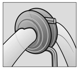
■ Dirigez le tuyau vapeur sur le joint caoutchouc dans la tige guide-fil.
