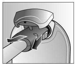
Débranchez le tuyau de vapeur du fer à repasser ou du Steamer de son raccordement à la tour.
