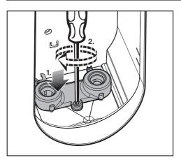
Serrez fermement la vis du capot du filtre à eau avec un tournevis cruciforme.
