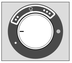
Les différents niveaux de température sont identifiés par des points sur la graduation du thermostat. Ces niveaux correspondent aux symboles internationaux utilisés pour le repassage.
