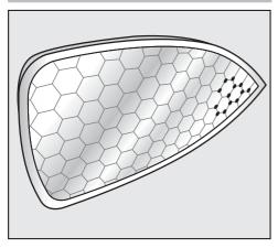
Nettoyez la semelle du fer, selon l'encrassement, par voie sèche ou humide avec un chiffon microfibres. Utilisez le chiffon microfibres exclusivement pour le nettoyage de la semelle du fer à repasser!
