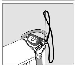
Pour éviter d'endommager ou de décolorer la housse de la table à repasser, posez toujours le fer sur le support repose-fer avant de commencer à repasser et pendant les pauses de repassage. Risque de basculement pour les fers à repasser placés sur le bord. Un fer à repasser placé sur le bord peut facilement basculer et tomber. Placez toujours le fer à repasser sur le support repose-fer avec la semelle tournée vers le bas.
