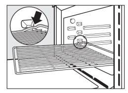
Lorsque vous la sortez, soulevez légèrement la grille par l'avant dès que la butée de sécurité est sortie au maximum de l'enceinte.
