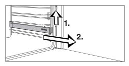
■ Soulevez le rail coulissant FlexiClip par l'avant (1.) et sortez-le en le faisant glisser le long de la barre (2.).
