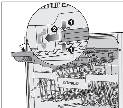
■ Appuyez sur les clips de sécurité des rails des deux côtés du tiroir à couverts ① et retirez en même temps les clips de sécurité ②.
