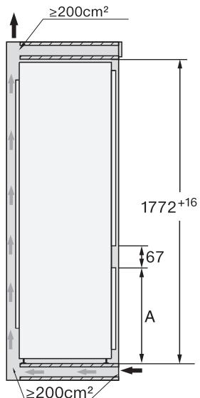
\* La consommation énergétique déclarée a été déterminée à partir d'une profondeur de niche de 560 mm. Avec une profondeur de niche de 550 mm, l'appareil fonctionne parfaitement mais consomme légèrement plus d'énergie.
