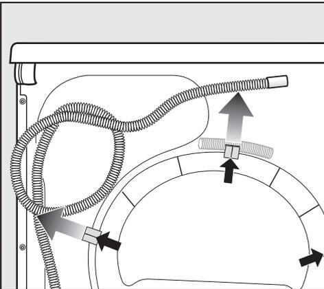
■ Retirez le tuyau de vidange des dispositifs de fixation.
