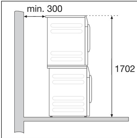
Un cadre de superposition\* est requis. Le montage doit être effectué par un technicien agréé par Miele.
