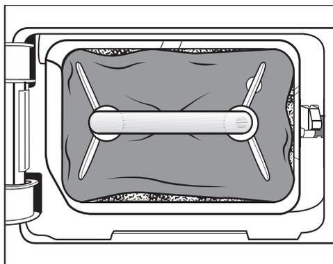
Les bords du filtre ne sont pas en contact avec le support et le filtre est déformé. Les peluches ne sont pas filtrées au niveau des bords et sont entraînées dans l'échangeur thermique. À la longue, l'échangeur thermique s'encrasse.
