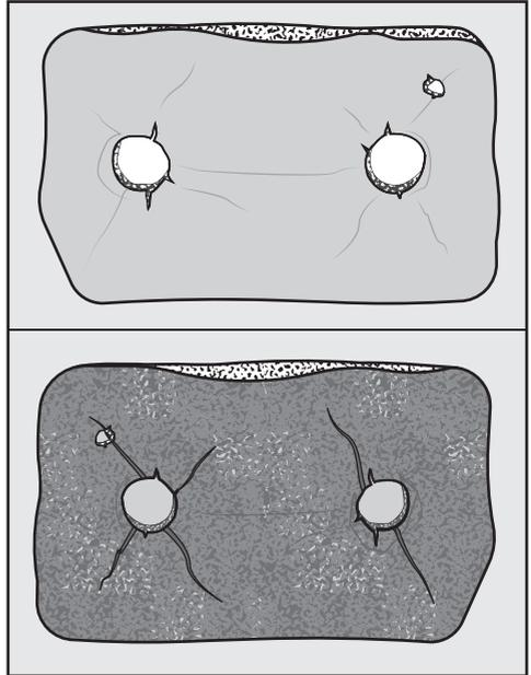
En présence de fissures et de fentes, les peluches sont entraînées dans l'échangeur thermique. À la longue, l'échangeur thermique s'encrasse.
