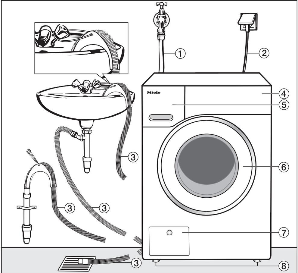
① Tuyau d'arrivée d'eau (résistant à la pression jusqu'à 7 000 kPa (70 bars))
