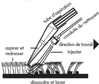
**T** Commencer le nettoyage dans un coin de la chambre et poser le suceur injection-extraction sur le tapis. Tirer la gachette du pistolet diffuseur (40) et produit nettoyant est injecté sur le tapis. Tirer ensuite le suceur, en ligne droite, lentement par-dessus le tapis.
