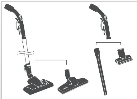
Raccordez le tube télescopique et/ou le suceur sélectionné pour l'application souhaitée à la poignée du flexible d'aspiration.
