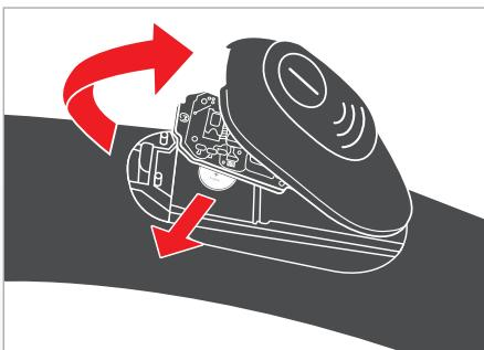
**Remplacement de la pile de la télécommande de la poignée du flexible d'aspiration\***
