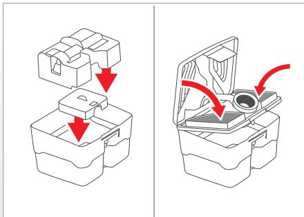
Uniquement pour l'aspiration-lavage et l'aspiration de liquides : si l'insert pour aspiration-lavage a été retiré, replacez-le vers le bas dans la cuve d'eau usée. Veillez à ce que le commutateur à flotteur fonctionne librement.
