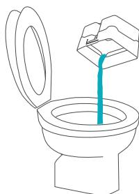
Videz/nettoyez la cuve d'eau usée de l'Aquafilter avant de remplir de nouveau le réservoir d'eau propre comme décrit précédemment (voir chapitre « Nettoyage », section « Nettoyer l'Aquafilter en cas de légère salissure »).
