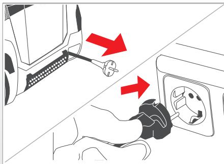
Prenez le câble au niveau de la prise de raccordement au secteur. Tirez le câble de raccordement au secteur à la longueur voulue. Branchez la prise de raccordement au secteur.
