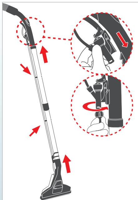
Raccordez le tube télescopique à la poignée du flexible d'aspiration et au suceur d'aspiration-lavage pour sols.
