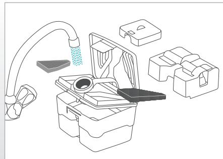
En cas de fort encrassement, retirez l'éjecteur en tournant le joint du raccord pour nettoyage.
