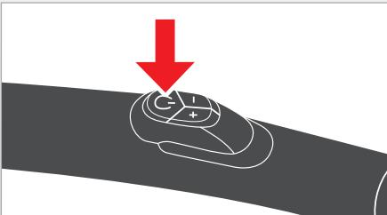
Om het apparaat uit te schakelen, drukt u de startknop iets langer in of - modelafhankelijk - drukt u op de -toets op de handgreep\*. Als u het apparaat opnieuw inschakelt, start het apparaat weer met de eerder geselecteerde zuigkracht, tenzij het apparaat tussendoor van het stroomnet is gescheiden.
