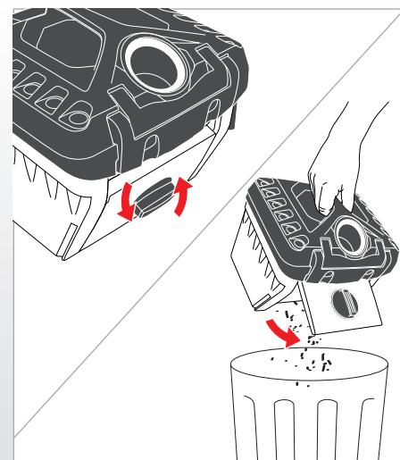
**Reinigen en drogen van de AQUA-Pure-filterbox (na elk gebruik)**
