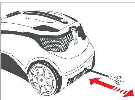
Débranchez la prise du secteur. Tirez légèrement le câble de raccordement en l'éloignant de l'appareil et relâchez-le. Le câble s'enroule automatiquement.
