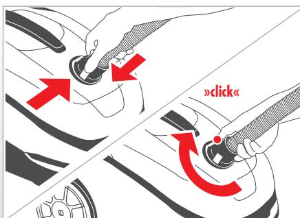
Raccordez le flexible d'aspiration à l'appareil.
