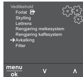
Fig. 7: Navigering til programmet Avkalking
