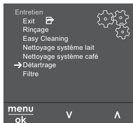
Fig. 7: Navigation vers le programme Détartrage
