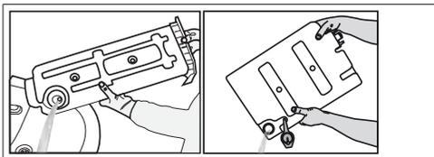
Si des fibres s'accumulent dans l'entonnoir du réservoir d'eau, retirez-les à l'eau courante. Remettez le réservoir d'eau en place.
