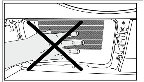
**i** Lorsque le couvercle du déflecteur d'air est retiré, il est normal d'avoir de l'eau dans la partie en plastique située devant le condenseur.
