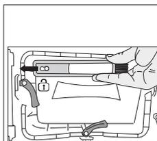
Tirez la brosse vers la gauche pour l'enlever. Vous pouvez utiliser la brosse de nettoyage pour nettoyer le filtre, la condensation de la surface et les fibres accumulées sur la porte.
