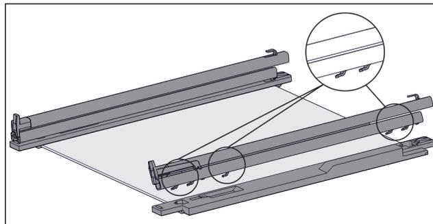
Fig. 106 Tablette en verre avec rails et pièces de retenue
