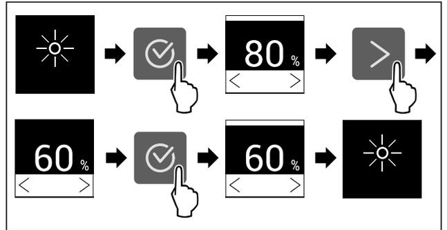
Fig. 40 Représentation à titre d'exemple : Passer de 80 à 60 %.
