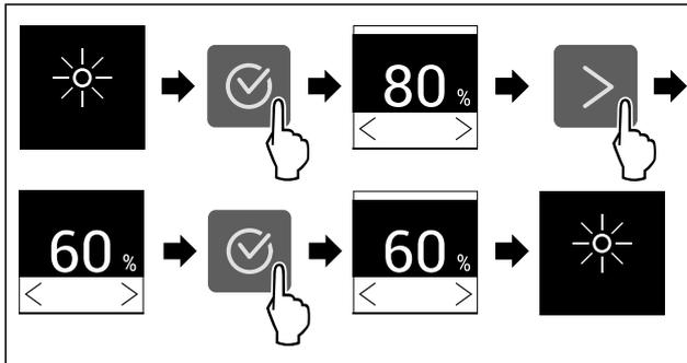
Fig. 60 Représentation à titre d'exemple : Passer de 80 à 60 %.
