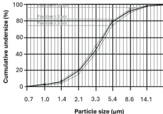
Die Messungen wurden mit einer Salbutamollösung mit einem „Next Generation Impactor“ (NGI) durchgeführt.
