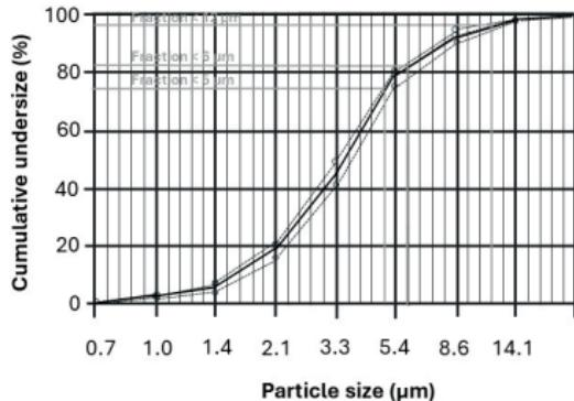
Las mediciones se realizaron con una solución de salbutamol con un «Next Generation Impactor» (NGI). Así pues, el diagrama puede no ser aplicable a suspensiones o medicamentos altamente viscosos. Puede obtener más información del fabricante de la medicación.
