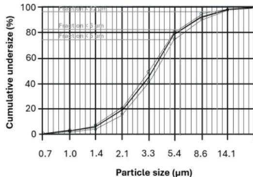
Измерения производились с использованием раствора сальбутамола при помощи импактора нового поколения Next Generation Impactor (NGI).
