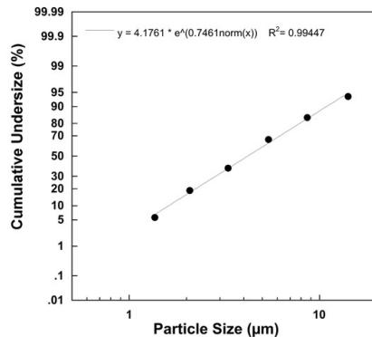
Las mediciones se realizan con una solución de fluoruro sódico con un "Next Generation Impactor" (NGI). Así pues, el diagrama puede no ser aplicable a suspensiones o medicamentos altamente viscosos. Puede obtener más información del fabricante de la medicación.
