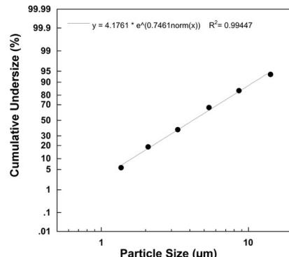
Pomiary zostały przeprowadzane za pomocą roztworu sodu i fluoru oraz urządzenia „Next Generation Impactor” (NGI).
