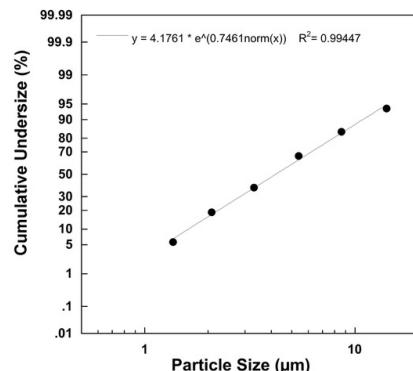
Die Messungen wurden mit einer Natrium-Fluorid-Lösung mit einem „Next Generation Impactor“ (NGI) durchgeführt.
