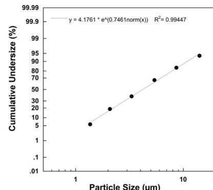
Измерения производились с использованием раствора фторида натрия при помощи импактора нового поколения «Next Generation Impactor» (NGI). Поэтому диаграмма может быть неприменима для супензий или очень густых лекарственных препаратов. Подробную информацию можно получить у производителя соответствующего лекарственно-го препарата.
