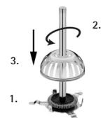
Per montare il WMF Choc System far scorrere il DISCO latte (9) nel supporto DISCO (8). Avvitare il manico (7) dall'alto fino a finecorsa nel supporto DISCO (8). Il DISCO latte (9) è così infilato in maniera flessibile nel supporto. Infilare il contenitore per il cioccolato (10) dall'alto sul manico (7) e farlo scorrere verso il basso fino a farlo scattare.
