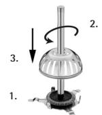
Når du skal sette WMF Choc System sammen igjen, trykker du melk-DISC (9) inn i DISC-braketten(8). Skru deretter håndtaket (7) helt inn i DISC-braketten (8) ovenfra. Melk-DISC (9) er nå fleksibelt festet i braketten. Trykk deretter sjokoladeburet (10) på håndtaket (7) ovenfra, og trykk det ned til det klikker på plass.
