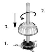
Sätt tillbaka WMF-chokladsystemet genom att trycka in DISC för mjölk (9) i fästet för DISC (8). Skruva sedan in handtaget (7) hela vägen i fästet för DISC (8) ovanifrån. DISC för mjölk (9) är nu monterad flexibelt vid fästet. Tryck sedan ned chokladkorgen (10) på handtaget (7) ovanifrån och tryck nedåt tills att den klickar fast.
