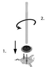
Для повторной сборки вставьте ДИСК для молока (9) в крепление ДИСКА (8) выемкой вверх. Затем до упора закрутите ось (7) сверху в крепление ДИСКА (8). ДИСК для молока (9) теперь закреплен с возможностью двигаться относительно крепления.
