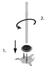
Kokoa järjestelmä uudelleen työntämällä maito-DISC (9) DISC-kannattimeen (8) siten, että lovi osoittaa ylöspäin. Ruuvaa sitten kahva (7) DISC-kannattimeen (8) ylhäältä päin. Maito-DISC (9) on nyt kiinnitetty joustavasti kannattimeen.
