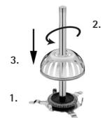
Для повторной сборки системы для шоколада WMF вставьте ДИСК для молока (9) в крепление ДИСКА (8). Затем до упора закрутите ось (7) сверху в крепление ДИСКА (8). ДИСК для молока (9) теперь закреплен с возможностью двигаться относительно крепления. Затем наденьте корзинку для шоколада (10) на ось (7) сверху и надавите вниз до щелчка.
