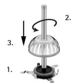
Om het WMF choc-systeem weer te monteren, duwt u de melk-SCHIIF (9) in de SCHIJF-houder (8). Schroef vervolgens de handgreep (7) van bovenaf helemaal in de SCHIJF-houder (8). De melk-SCHIIF (9) is nu flexibel aan de houder bevestigd.
