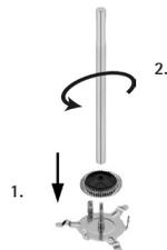
For montering, skub Mælke-DISC (9) i DISC-holderen (8) med indhakked opad. Skru derefter håndtaget (7) helt ind i DISC-holderen (8) ovenfra. Mælke-DISC (9) er nu fastgjort fleksibelt i holderen.
