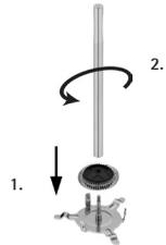
Zur Montage setzen Sie die Milch-DISC (9) auf die Führung der DISC Halterung (8). Schrauben Sie den Griff (7) von oben bis zum Anschlag in die DISC-Halterung (8). Die Milch-DISC (9) ist somit flexibel in der Halterung gelagert.
