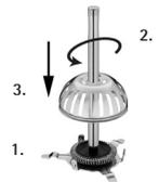
Zur Montage des WMF Choc Systems schieben Sie die Milch-DISC (9) mittig in die DISC Halterung (8). Schrauben Sie nun den Griff (7) von oben bis zum Anschlag in die DISC-Halterung (8). Die Milch-DISC (9) ist somit flexibel in der Halterung gelagert. Stecken Sie nun den Schokokäfig (10) von oben auf den Griff (7) und schieben Sie ihn nach unten bis er einrastet.
