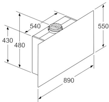
Appareil en mode circulation d'air sans canal
